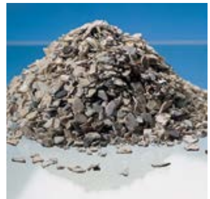
In der Wertstoffsartierung wird PS-Mahlgut mit hohem Reinheitsgrad abgeschieden
